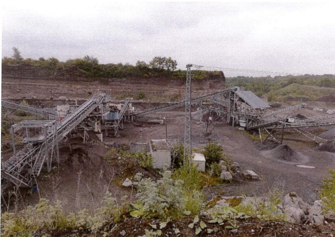
Abbildung 3: Lavavorkommen „Am Wingertsberg“ Gemarkung Mendig Abbau und Aufbereitung des Schottertragschichtmaterials.
